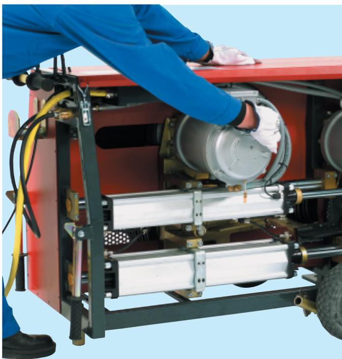
■ Partendo dalla puleggia di guida, o asse cavo superiore, situato sul lato non teso, avvolgere il filo connesso sulle ruote conduttrici  $\varnothing$  280 mm (vd. adesivo sull'a-
