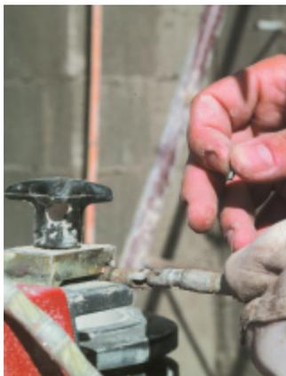
■ Portare manualmente il motore d'azionamento sulla slitta di guida fino alla posizione desiderata. Per fare questo, i due raccordi dell'aria compressa – posti sul lato posteriore della macchina – devono essere allacciati o collegati insieme (in modo che l'aria possa circolare nei cilindri dell'aria compressa).
