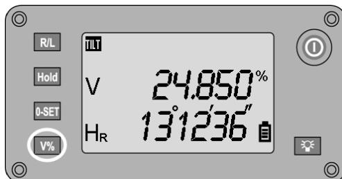
Vertikalringsavläsningen kan ställas om mellan grad- och procentindikering.
