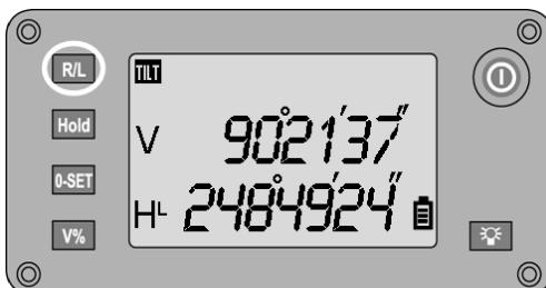
Kierunek pomiaru kąta poziomego można zmieniać naciskając przycisk **R/L**: w prawo — w kierunku zgodnym z ruchem wskazówek zegara i w lewo — w kierunku przeciwnym do ruchu wskazówek zegara.
