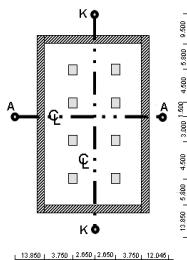
Augstuma atzīmes būvobjekta teritorijā un ap to, kā arī būvkonstrukciju asis parasti pirms būvdarbu uzsākšanas uzmēra un atzīmē mērniecības uzņēmums.
