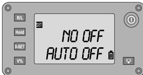
Включение/выключение функции автоматического отключения прибора
