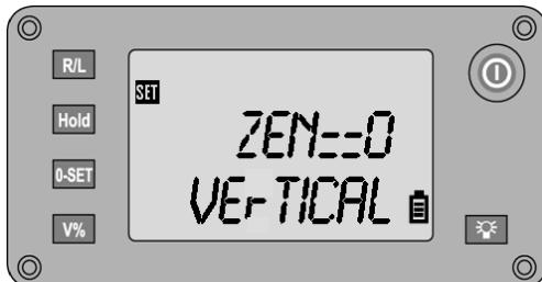
Innstilling av Zenit, dvs. referanseposisjon for vertikalavlesninger
