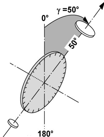
Ved at vertikalsirkelen kan innrettes med  $0^\circ$  på gravitasjonsretningen eller med  $0^\circ$  på horisontalretningen, bestemmes tenkte vinkler fra gravitasjonsretningen.
