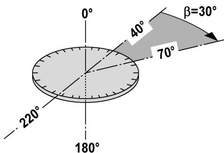
A partir das leituras horizontais do limbo medidas ( $70^\circ$  até um alvo e  $40^\circ$  até ao outro alvo) pode calcular-se o ângulo incluído  $70^\circ - 40^\circ = 30^\circ$ .
