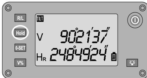
Vaakakehälukema voidaan painiketta **HOLD** painamalla asettaa pitoon, minkä jälkeen voidaan tähdätä uuteen kohteeseen ja painiketta uudelleen painamalla vapauttaa kehälukema.
