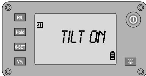
Conexión y desconexión del compensador
