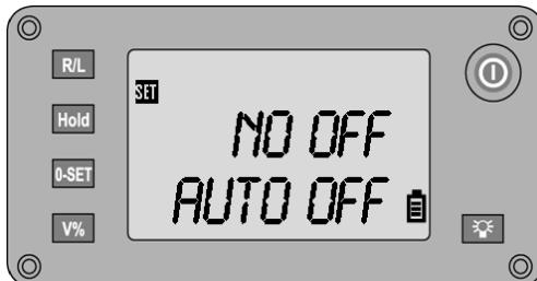
Aktivering og deaktivering af instrumentets automatiske slukning
