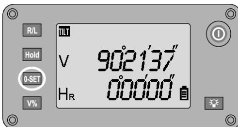
Odczyt wskazań koła poziomego można w dowolnej chwili wyzerować naciskając przycisk **0-SET**, wyznaczając tym samym punkt odniesienia lub punkt zerowy koła poziomego.
