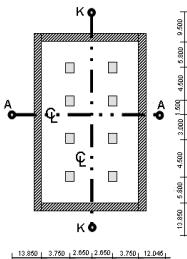
Em geral, uma empresa de topografia marca primeiro cotas de referência e eixos de construção dentro e à volta da área de construção, antes do início da obra.
