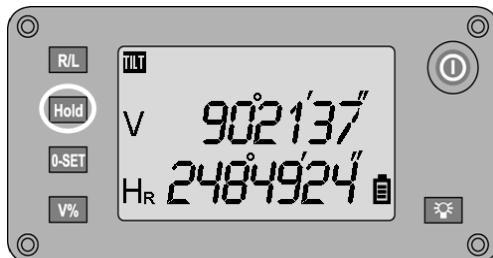
Odczyt wskazania na kole poziomym można zatrzymać naciskając przycisk **HOLD**, następnie wyznaczyć nowy cel i zwolnić odczyt na kole przez ponowne naciśnięcie przycisku.
