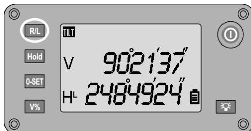
Måleretningen for den horisontale vinkelmåling kan ændres mellem højre (R) – med uret og venstre (L) – mod uret ved at trykke på **tasten R/L**.
