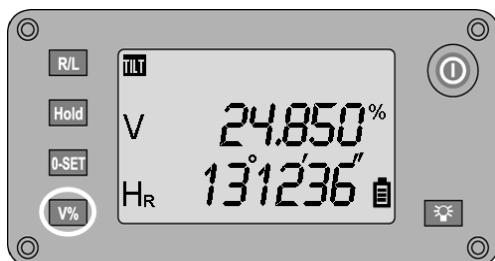
Vertikalkredsaflæsningen kan skiftes mellem grad- og procentvisning (%).
