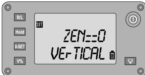
Indstilling af zenith og referencepositionen for vertikalkredsafslæsninger
