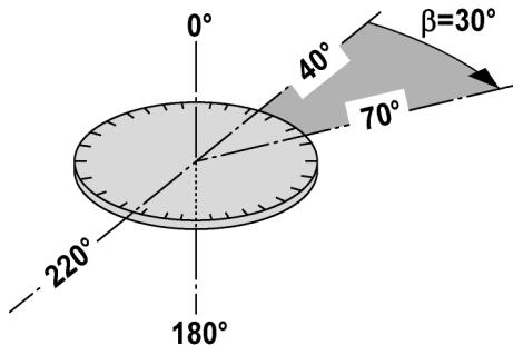
Mitatuista vaakakehälukemista, jotka sijaitsevat  $70^\circ$  kulmassa toiseen kohteeseen ja  $40^\circ$  kulmassa toiseen kohteeseen nähdyn, voidaan laskea väliin jäävä kulma  $70^\circ - 40^\circ = 30^\circ$ .
