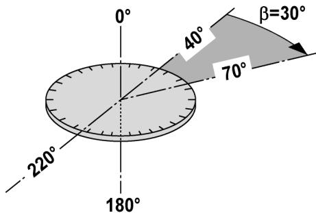
Les lectures de mesure circulaires horizontales à  $70^\circ$  par rapport à une cible et à  $40^\circ$  par rapport à l'autre cible permettent de calculer l'angle inclus  $70^\circ - 40^\circ = 30^\circ$ .
