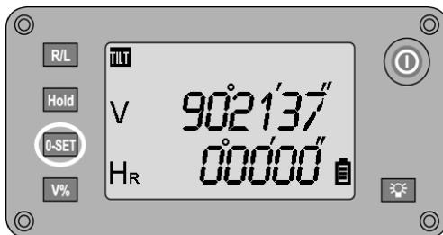
Die Horizontalkreisablesung kann jederzeit durch Drücken der Taste **0- SET** auf Null gesetzt werden und somit der Bezugs- oder Nullpunkt für den Horizontalkreis gesetzt werden.
