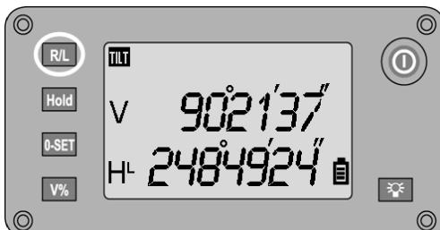
Vaakakehän kulmamittauksen mittaussuuntaa voidaan **painiketta R/L** painamalla muuttaa oikealle eli myötäpäivään ja vasemmalle eli vastapäivään.
