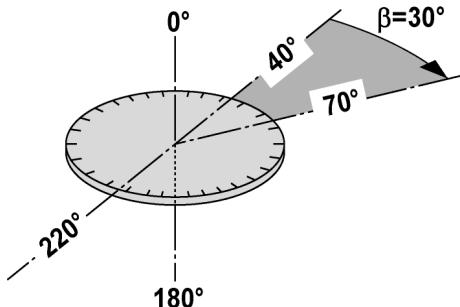
In base ai valori rilevati dal cerchio orizzontale con  $70^\circ$  verso un obiettivo e  $40^\circ$  verso l'altro è possibile calcolare l'angolo incluso  $70^\circ - 40^\circ = 30^\circ$ .
