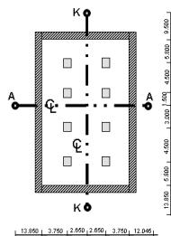
Por lo general, antes de comenzar con los trabajos de construcción, una empresa de topografía marca las alturas y los ejes constructivos en la zona de obra y en torno a ella.
