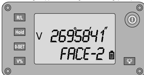
6. Växla nu till läge 2 och rikta in siktet på det valda målet i läge 2.
