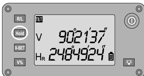
A leitura do limbo horizontal pode ser fixada premindo a tecla **HOLD**. Em seguida aponta-se ao novo alvo e, premindo novamente a tecla, solta-se de novo a leitura do limbo.
