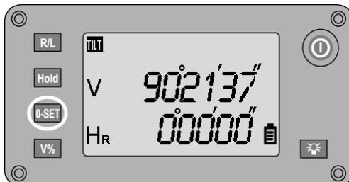
De aflezing van de horizontale cirkel kan altijd op nul worden gezet door toets **0- SET** in te drukken, waardoor het referentie- of nulpunt voor de horizontale cirkel wordt ingesteld.
