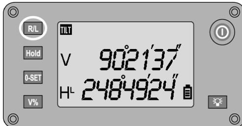
Направление для измерения горизонтальных углов может меняться посредством нажатия кнопки **R/L** на «вправо» (по часовой стрелке) и «влево» (против часовой стрелки).
