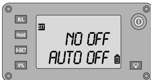
Włączanie i wyłączanie funkcji automatycznego wyłączania urządzenia
