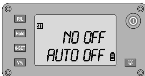
Activación y desactivación de la desconexión automática de la herramienta
