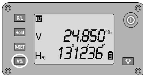
Vertikalringavlesningen kan stilles om mellom grad- og prosentvisning (%).
