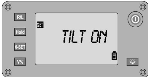
Zapnutí, resp. vypnutí kompenzátoru
