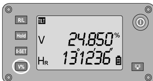
Odečítání hodnot na svislém kruhu lze přepínat mezi zobrazením ve stupních a v procentech (%).
