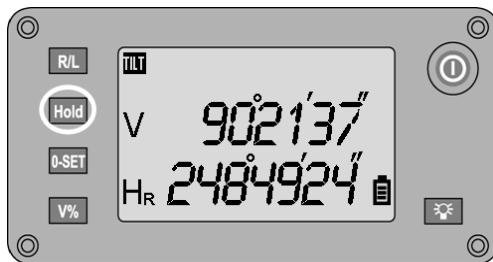
Odčítanie hodnôt na vodorovnom kruhu možno stlačením tlačidla **HOLD** pridržať, potom zamerať nový cieľ a opäťovným stlačením tlačidla odčítanie hodnôt znova uvoľniť.
