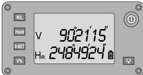
7. Trykk på tasten **OSET** for å utføre vinkelmåling i stilling 2.
