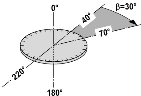
Von den gemessenen horizontalen Kreisablesungen mit  $70^\circ$  zum einen Ziel und  $40^\circ$  zum anderen Ziel kann der eingeschlossene Winkel  $70^\circ - 40^\circ = 30^\circ$  berechnet werden.
