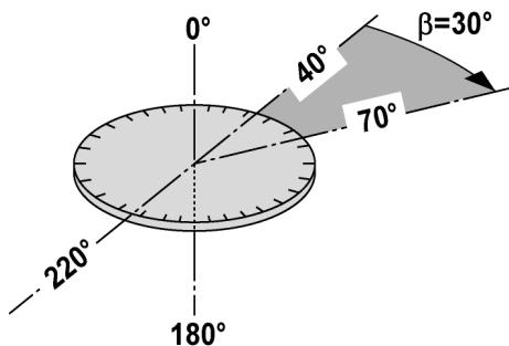
Na podstawie zmierzonych odczytów na kole poziomym wynoszących  $70^\circ$  względem jednego celu i  $40^\circ$  względem innego celu istnieje możliwość wyliczenia kąta pomiędzy nimi wynoszącego  $70^\circ - 40^\circ = 30^\circ$ .
