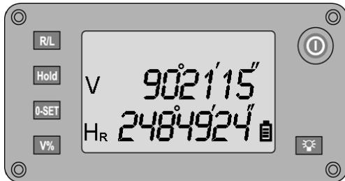
7. Затем нажмите кнопку **0-SET** для измерений углов в положении 2. После второго измерения выполняется расчёт и сохранение корректировки для вертикального круга и отображается текущий угол.
