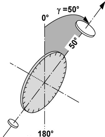
Kuna vertikaalringi saab  $0^\circ$  rihtida vertikaalsuunas või  $0^\circ$  horisontaalsuunas, on siin nurgad määratud vertikaalsuunast lähtudes.
