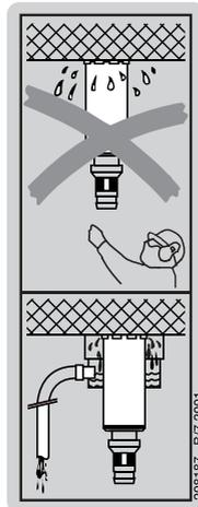
En los trabajos en techos está prescrita la utilización del sistema colector de agua junto a un aspirador de agua.
