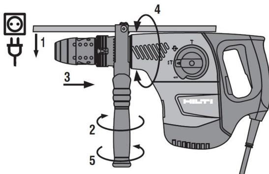
1. Spingere il supporto (nastro di serraggio) e l'impugnatura laterale dalla parte anteriore lungo il porta-utensile fino a raggiungere la scanalatura prevista allo scopo.
