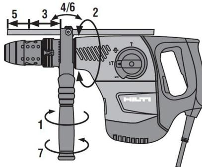
1. Drehen Sie am Griff, um die Halterung (Spannband) des Seitenhandgriffs zu lösen.
