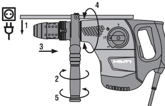
1. Schieben Sie die Halterung (Spannband) und den Seitenhandgriff von vorne über die Werkzeugaufnahme bis zur dafür vorgesehenen Nut.
