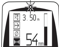
Betonirauta sijaitsee skannerin keskiliinalla, ja sijainti voidaan merkitä merkintäkynällä PUA 70. Syvyyssmittauksen tarkkuutta voidaan lisätä, kun syötetään betoniraudan oikea halkaisija tai siirrytään mittaustilaan, jossa on syvyyden tarkempi määritys (ks. 7.2.5.2)
