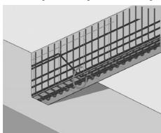
Tilanteissa, joissa betoniraudoitusta ei saa vaurioittaa, varmista, että teet kuvaskannauksen vähintään rakenneosan kolmelta sivulta, jotta myös työntöraudat (jotka ovat betoniin kulmittain) voidaan tunnistaa.
