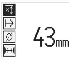
S tipkama sa strelicama odaberite ograničenu funkciju mjerena dubine te pritisnite tipku za potvrđivanje.
