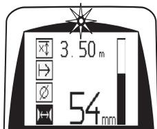
Armirno železo leži v središčnici detektorja in se ga na površini lahko označi z markerjem PUA 70. Natančnost merjenja globine lahko povečate tako, da vnesete pravilen premer armirnega železa ali pa ga v načinu merjenja zamenjate s točno določeno globino (glejte 7.2.5.2)
