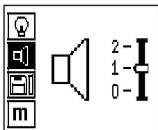
Nastavitev glasnosti zvočnega signala pri merjenju. Za doseg posameznih možnosti uporabite smerno tipko. S potrditveno tipko izberite želeno možnost in pritisnite tipko za prekinitev za vrnitev v meni nastavitvev.
