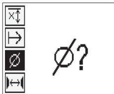
Če ni izbran noben premer železa, detektor globino izmeri tako, kot da je nastavljen srednji premer železa ustrezne standardne vrste.
