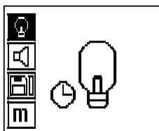
Samodejna osvetlitev ozadja. S to možnostjo se osvetlitev ozadja po petih minutah brez aktiviranja tipke izklopi in pri naslednjem pritisku tipke znova vklopi.
