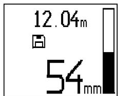
Za beleženje položaja in globine znanega armirnega železa, detektor položite na površino in s quickscan iskanjem poiščite mesto, pod katerim ni železa. Začetno točko označite z markerjem PUA 70 in pritisnite tipko za beleženje. Na zaslonu se prikaže simbol diskete, kar pomeni, da detektor zapisuje podatke. Detektor premikajte po površini.
