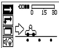
Vklopite detektor. Samodejno se najprej izbere simbol quickscan. S potrditveno tipko v glavnem meniju izberite quickscan.
