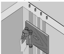
Hrapava površine (npr. betonske površine, na katerih so vidne spremembe) povzročajo dodatno šumenje v signalu, tako da pod temi pogoji določanje globine ali premera armirnega železa ni možno. V takšnem primeru je skeniranje skozi tanko oporno ploščo zelo primerno. Zgoraj navedeno navodilo glede odštevanja debeline plošče velja tudi tukaj.
