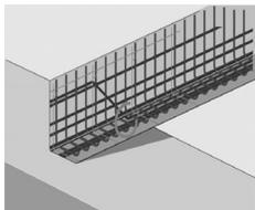
V primerih, ko se armatura ne sme poškodovati, pazite, da bo postopek imagescan opravljen na najmanj treh straneh zgradbe, da se prepoznajo tudi strižni drogi (ki so v betonu razporejeni pod enim kotom).
