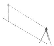
Sur des surfaces « normales », le faisceau laser mesure sans l'aide d'un réflecteur spécifique.
