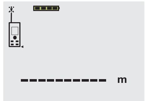
Ziel anvisieren. Zur Distanzmessung die Messtaste noch einmal drücken. Das Ergebnis wird in der Regel innerhalb einer knappen Sekunde in der Ergebniszeile angezeigt und der Laserstrahl schaltet ab.
