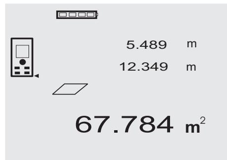
Die einzelnen Schritte zur Flächenmessung werden mit der entsprechenden Grafik in der Anzeige unterstützt. Um z.B. die Grundfläche eines Raumes zu bestimmen, wird folgendermassen vorgegangen:
