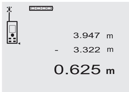
Einzeldistanzen können bequem subtrahiert werden, um z.B. den Abstand von der Unterkante vom Rohr zur Decke zu bestimmen. Dazu wird die Distanz vom Fußboden Unterkante Rohr von der Distanz bis zur Decke subtrahiert. Wird dazu noch der Rohrdurchmesser zum Abzug gebracht ist das Ergebnis der Zwischenabstand Oberkante Rohr zur Decke.
