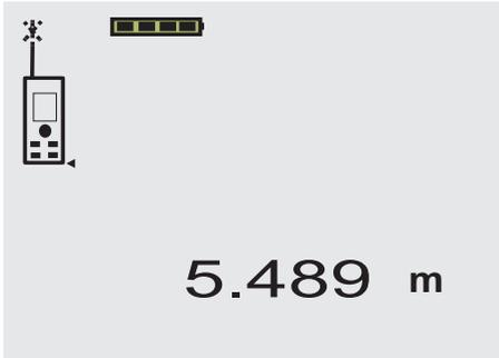
Bei weiteren Distanzmessungen werden bis zu 3 vorherige Distanzen in den Zwischenergebniszeilen angezeigt, d.h. insgesamt die 4 zuletzt gemessenen Distanzen werden angezeigt.
