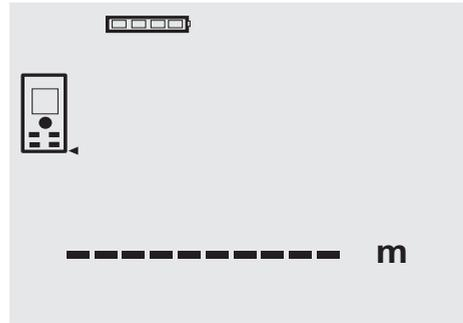
Messtaste einmal drücken. Der rote Laserstrahl wird eingeschaltet und ist mit einem Punkt auf der Zielfläche sichtbar. In der Anzeige ist dieser Zielmodus mit blinkendem Lasersymbol sichtbar.
