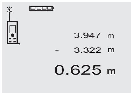
È possibile sottrarre comodamente le distanze, ad esempio per calcolare la distanza dal bordo inferiore di un tubo al soffitto. In questo caso viene sottratta la distanza dal pavimento o dal bordo inferiore del tubo fino al soffitto. Sottraendo ancora il diametro del tubo, il risultato sarà la distanza dal bordo superiore del tubo al soffitto.
