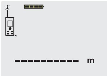
Mirare il bersaglio. Per la misurazione delle distanze, premere ancora una volta il tasto di misurazione. Il risultato di norma viene visualizzato entro un secondo sulla riga dei risultati e il raggio laser di misurazione si spegne.
