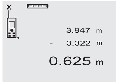
Podem facilmente subtrair-se distâncias individuais, por ex. para determinar a distância entre o canto inferior de um tubo e o tecto. Para chegar ao resultado, subtrai-se à distância entre o chão e o tecto a distância do chão ao canto inferior do tubo. Se adicionalmente, subtrairmos
