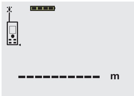
Apontar ao alvo. Pressionar a tecla de medição outra vez para efectuar a medição de distância. O resultado aparece, normalmente em menos de um segundo, na linha de resultados. O raio laser desliga-se.
