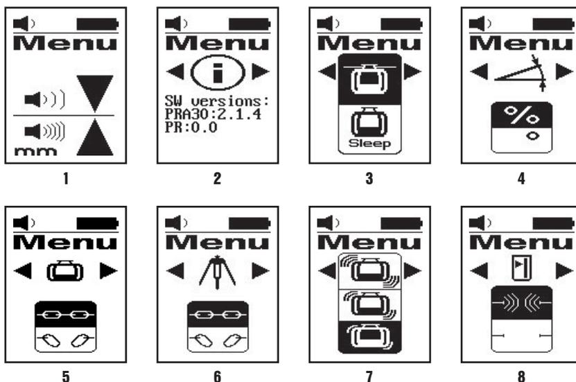
1. Al encender el receptor láser, mantenga pulsada la tecla de encendido/apagado durante dos segundos. El menú aparece en la pantalla.
