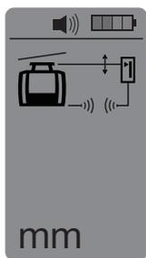
5. Lea la inclinación entre ambos puntos (de la herramienta y del receptor láser) en la pantalla del receptor láser.
