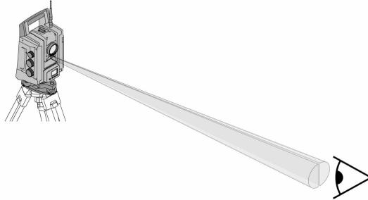
Die Einweishilfe besteht aus einer Austrittsöffnung am Fernrohr, aus der je zur Hälfte grünes und rotes Licht austritt.
