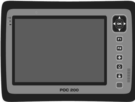
Das Bedienfeld am Controller besteht aus insgesamt 7 mit Symbolen bedruckten Knöpfen und einem berührungsempfindlichen Bildschirm (Touchscreen) für die interaktive Bedienung.
