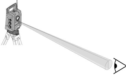
Die Einweishilfe besteht aus einer Austrittsöffnung am Fernrohr, aus der zur Hälfte grünes und rotes Licht austritt.
