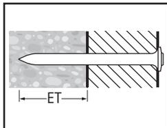
ET Profundidad de penetración: 22 mm (máx.
