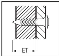
ET Profundidad de penetración:  $12 \pm 2$  mm
