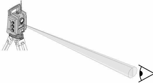
L'ausilio di allineamento è composto da un'apertura di uscita sul cannocchiale, dalla quale fuoriesce una luce in parte verde e in parte rossa.
